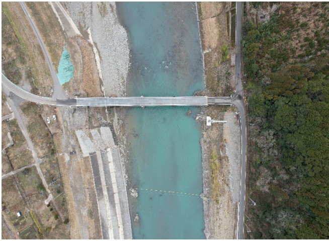
撤去完了 (旧橋下部工を利用した車両用仮設栈橋設置)
