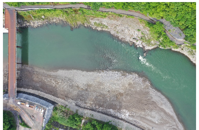
撤去完了（旧橋位置へ作業構台設置・残置）
